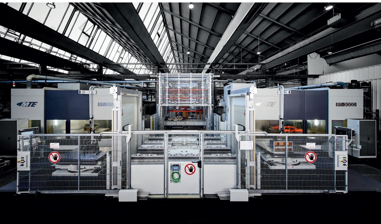
1 Mit dem Turmlager 'Unitower CNC' lassen sich CNC-Bearbeitungszentren automatisch und platzsparend bestücken © Kasto
